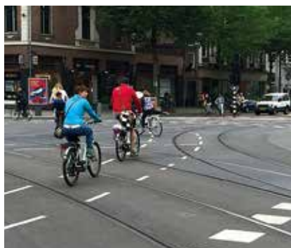
写真⑦ 交差点内でも直進、左折の自転車の通行帯が明確になっている。
