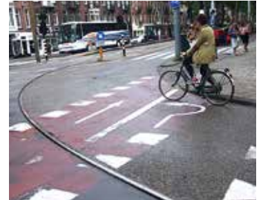
写真⑧ 左折用の待機場所が設けてあるアムステルダムの自転車レーン。
