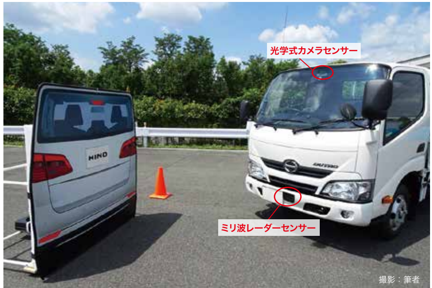
小型トラックの上部、ちょうどルームミラーの外側に向けて光学式カメラセンサーを、そしてナンバープレートの左側にミリ波レーダーセンサーをそれぞれ搭載しています。左側は前走車に見立てたダミーです。開発時はこうしたダミーに向かって走り警報ブザーやディスプレイ表示、さらには自律自動ブレーキが正しく機能するかを確認します。
