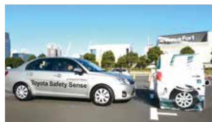
予防安全性能アセスメントではこのようにターゲット(模擬車両)に対して規定の速度で走行し、警報ブザーによる報知があるか、自動ブレーキが正しく作動するかなどのテストが行われます。
