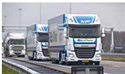
写真① トラック隊列自動走行実験の様子 (Ricardo社説明資料より抜粋)
