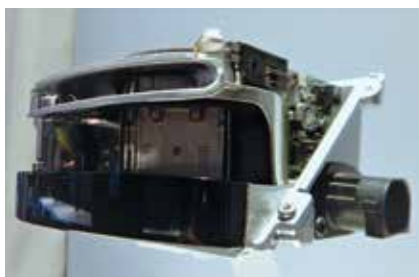
②アウディに搭載されたレーザースキャナー。波長905nm (ナノメートル) / 4n秒の赤外線パルスで145度の広範囲に対して発振しその反射光を750回転/分のフォトダイオードで検出して3次元での物体検出を行う
