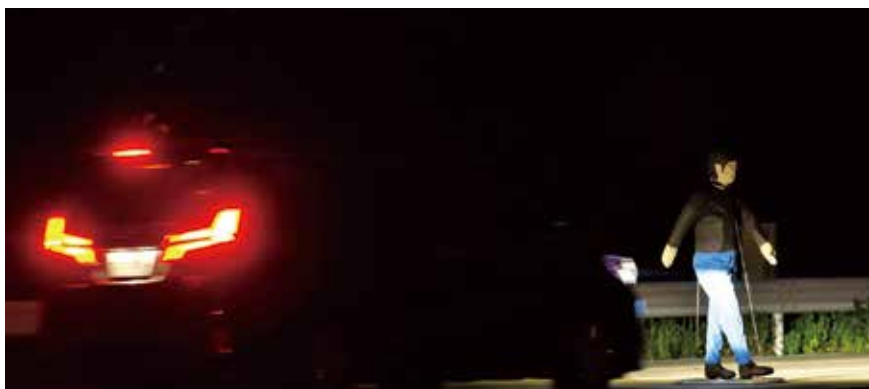
①月の明かりに近い1ルクスの光源とヘッドライトの灯りがあれば、夜間の歩行者を認識することができるトヨタの衝突被害ブレーキシステム。既存の光学式カメラセンサーを進化させ解析技術を改良したことで実現
