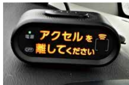
③プリウス/アクアに搭載可能な踏み間違い加速抑制システムの表示装置 (警報ブザー用のスピーカーを内蔵)。この表示装置にはセンサーが物体を認識している事を示す黄色の電波マークが表示される
