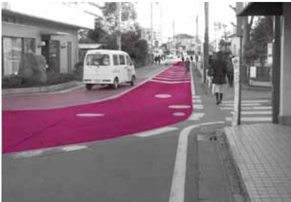
写真④ 進行方向毎にレンガ色とブルー（写真ではレンガ色と赤）に色分けされたカラー舗装と「速度おとせ」の文字と「<<」印の路面表示によりクルマの速度を抑制
